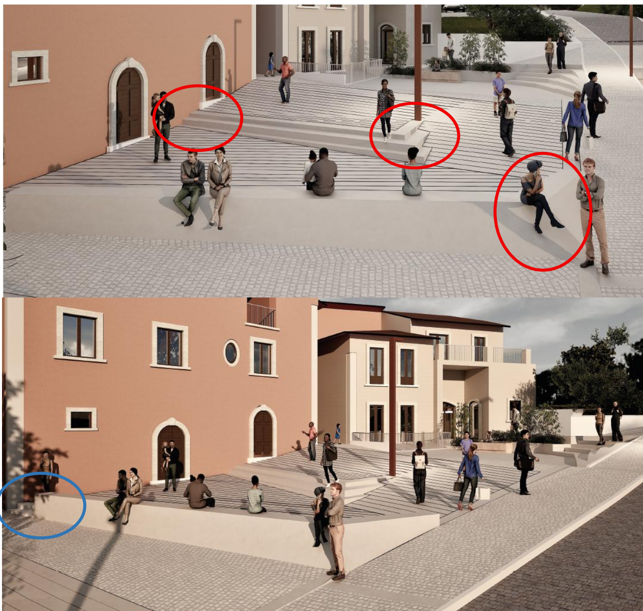
Render di progetto esecutivo: nel cerchio blu si notano ulteriori gradini (non accessibili)
